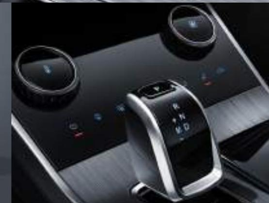
Palanca de cambios tipo **Joystick**
